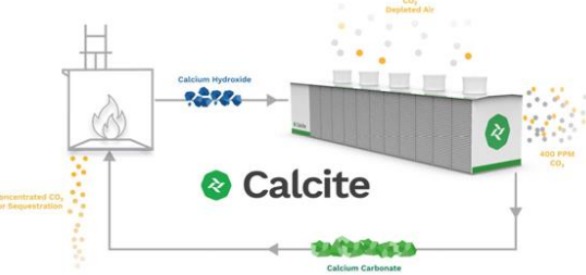
8 RiversのDAC技術“Calcite”概要図
